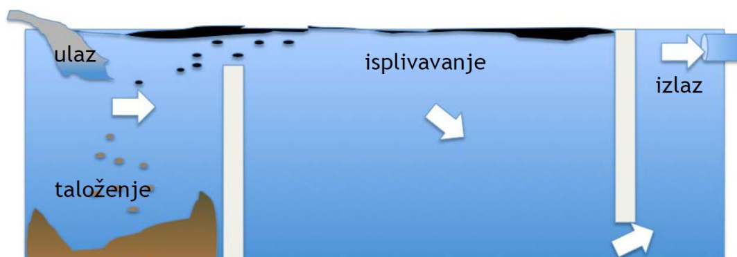
Slika 14: Princip funkcioniranja separatora
