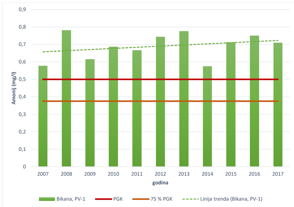
Slika 21. Trend promjene prosječnih godišnjih koncentracija amonija na priljevnom području vodocrpilišta Bikana na GTPV Legrad - Slatina
