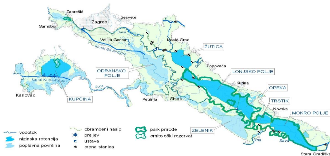
Sl. 2.3 Sustav obrane od poplava Srednje posavlje
