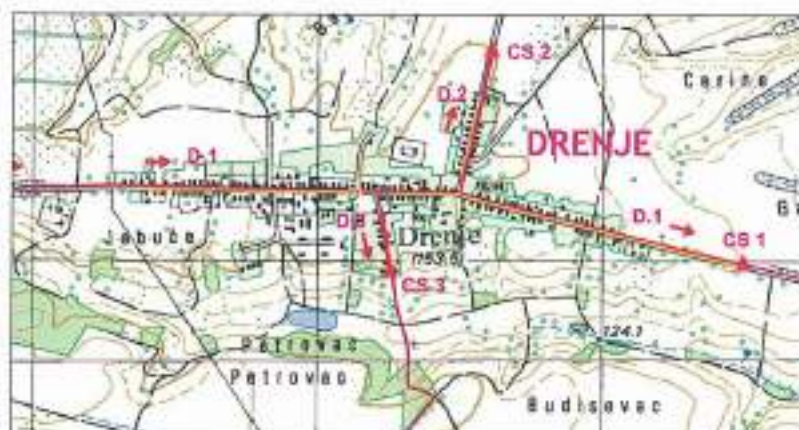
Slika 4.48: Planirani sustav odvodnje naselja Drenje.
