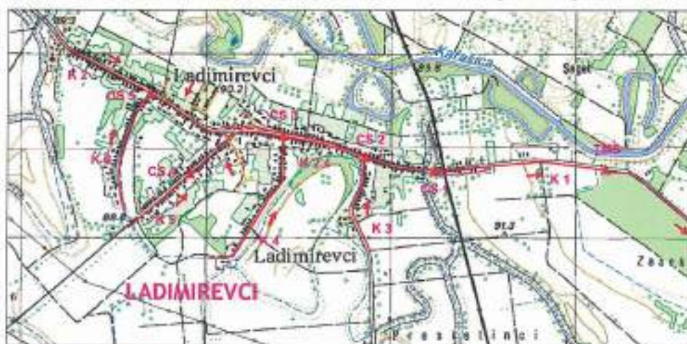
Slika 4.23: Planirani sustav odvodnje naselja Ladimirevci.
