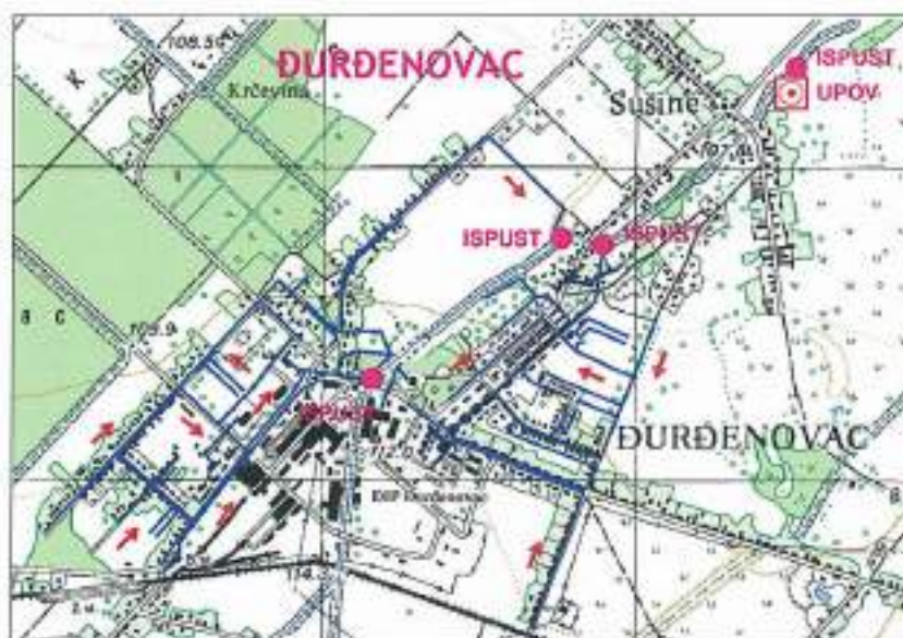
Slika 4.38: Sustav odvodnje Đurđenovca.
