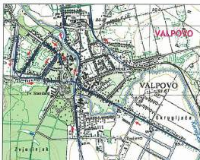
Slika 4.21: Sustav odvodnje grada Valpova.
