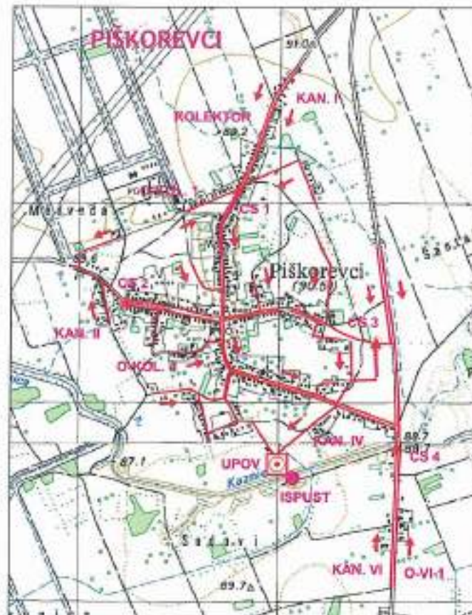
Slika 4.59: Planirani sustav odvodnje otpadnih voda naselja Piškorevci.
