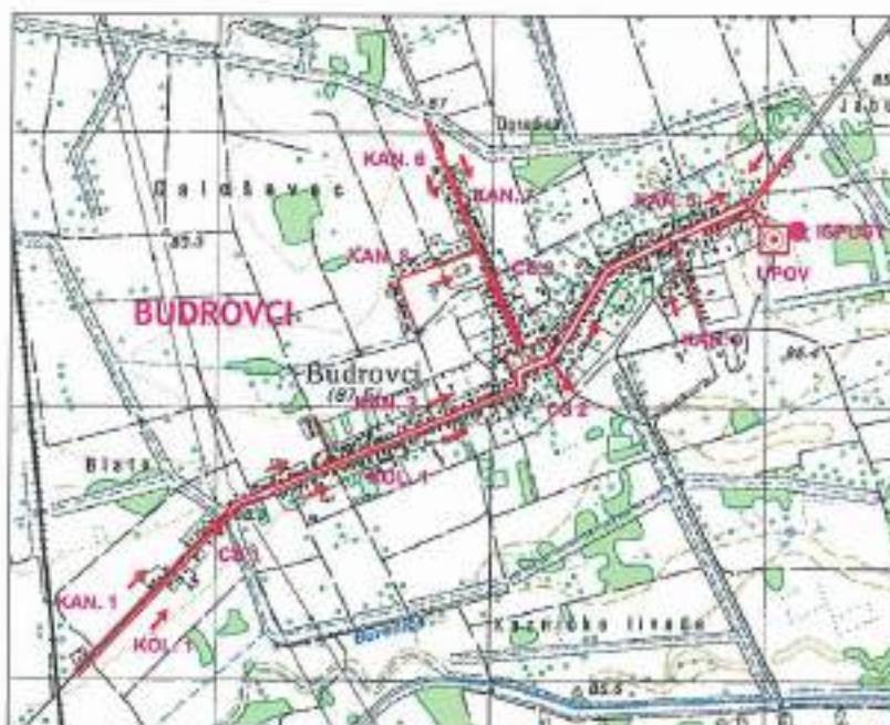
Slika 4.60: Planirani sustav odvodnje otpadnih voda naselja Budrovci.
