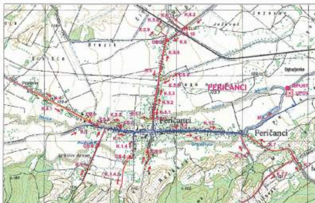
Slika 4.42: Planirani sustav odvodnje naselja Peričanci.
