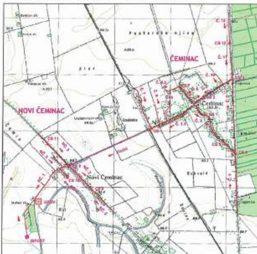
Slika 4.3: Planiran sustav odvodnje i pročišćavanja otpadnih voda naselja Čeminac i Novi Čeminac.
