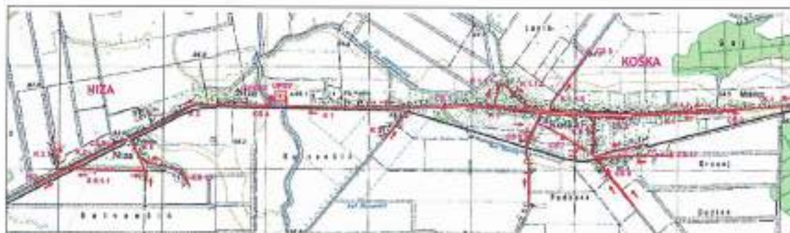
Slika 4.27: Planirani sustav odvodnje naselja Koška i Niza.
