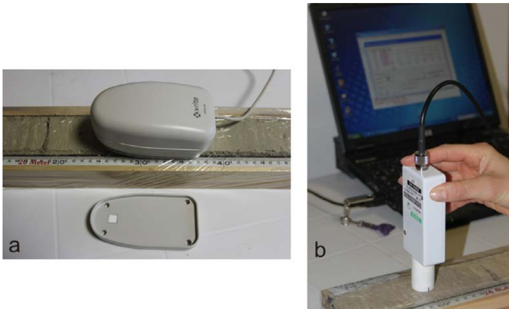
Slika 3-20 a) Xrite uređaj za spektralno određivanje boje i kalibracijski standard bijeli opal; b) Bartingtonov uređaj za mjerenje magnetskog susceptibiliteta, s detektorom za površinska mjerenja (MS2E).
