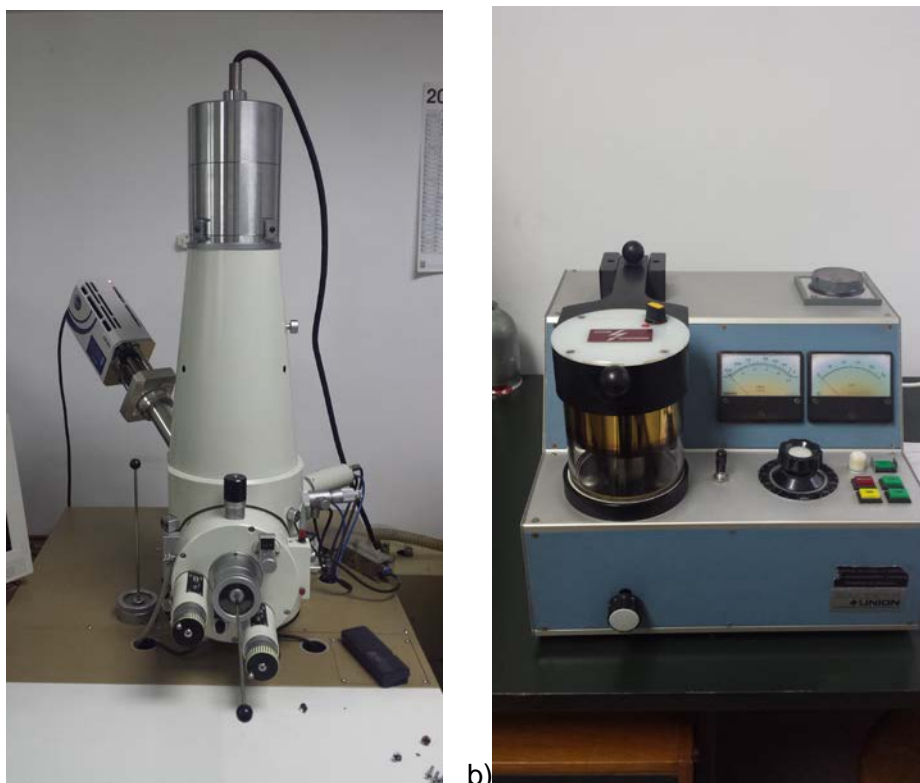
Slika 3-22 a) Skenirajući elektronski mikroskop Jeol; b) uređaj za naporivanje uzorka.
