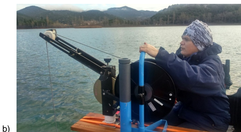
Slika 3-3 Mjerenje "in situ" parametara multiparametarskim sondama a) WTW b) SEBA KLL-Q
