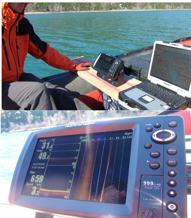
Slika 3-5 Ultrazvučni dubinomjer sa jednom zrakom i panoramskim dubinomjeom firme Hummingbird model 999ci HD SI Combo pomoću kojeg je načinjena batimetrijska karta Baćinskih jezera.
