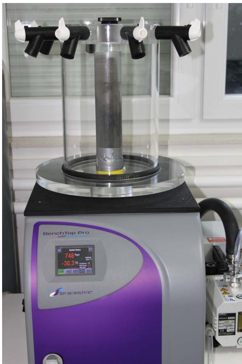
Slika 3-18 Uređaj za sušenje uzoraka zamrzavanjem – liofilizator ( freeze dryer ).
