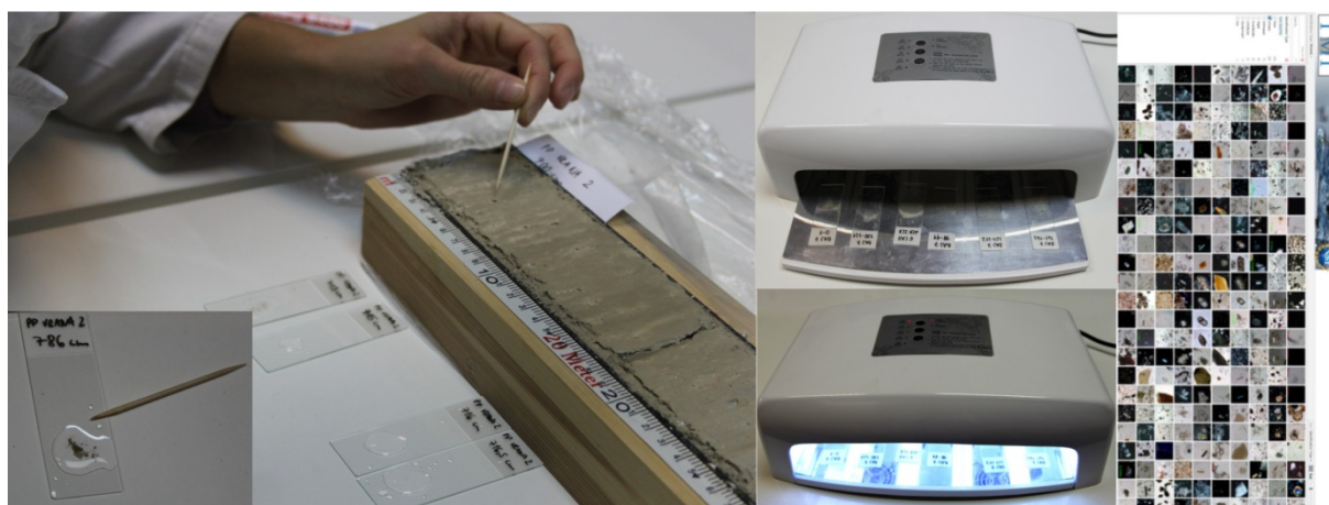
Slika 3-21 Izrada „smear slide“ preparata za mikroskopsku analizu nekonsolidiranih uzoraka, pomoću UV lampe i interpretacija podataka uz pomoć TMI baze.
