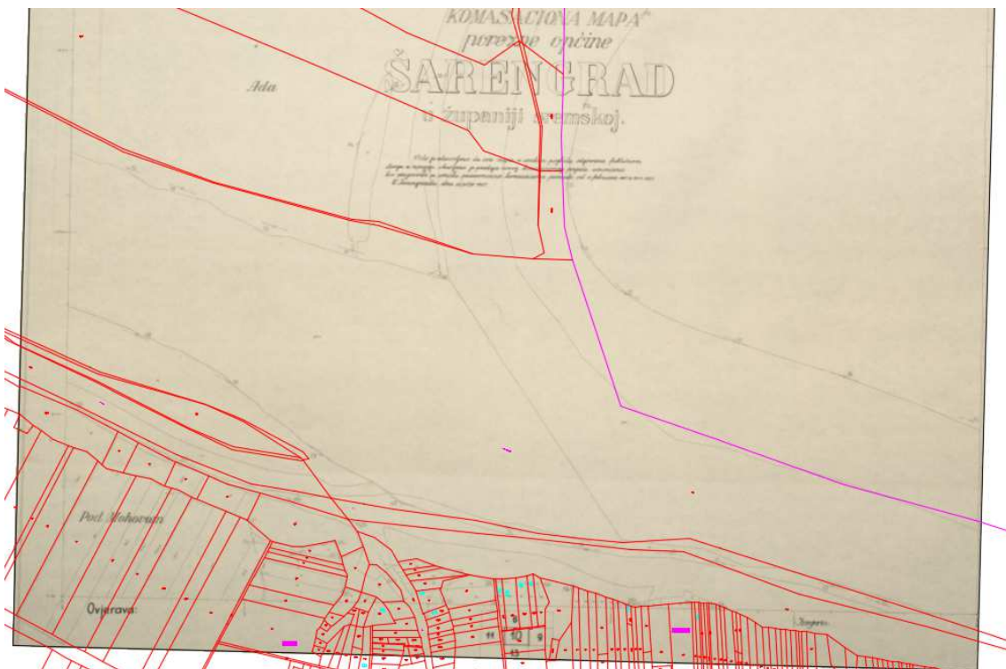
Slika 37 Usporedba podataka katastarskog plana iz 1863g. sa današnjim katastarskim planom na lokaciji Šarengradske ade – Dunav na planu iz 1863. još uvijek ide starim tokom; plan je izrađen prije prokopavanja kanala kojim je izravnana tok između Opatovca i Šarengrada
