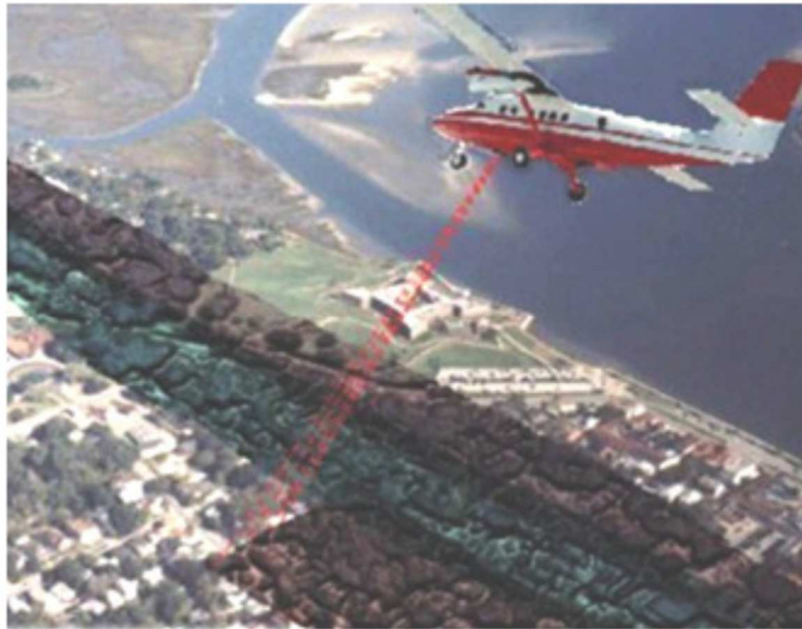
Slika 10 Princip ALS-a (Gajski 2007)
