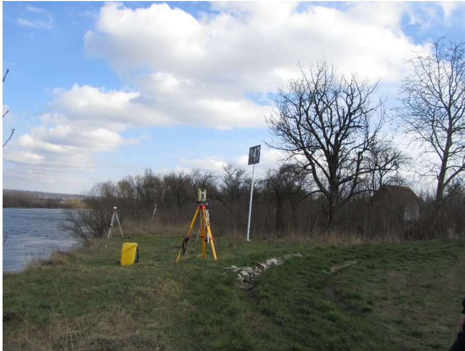
Slika 60 Određivanje koordinata sfera totalnom stanicom u svrhu georeferenciranja podataka skeniranja (oblaka točaka)
