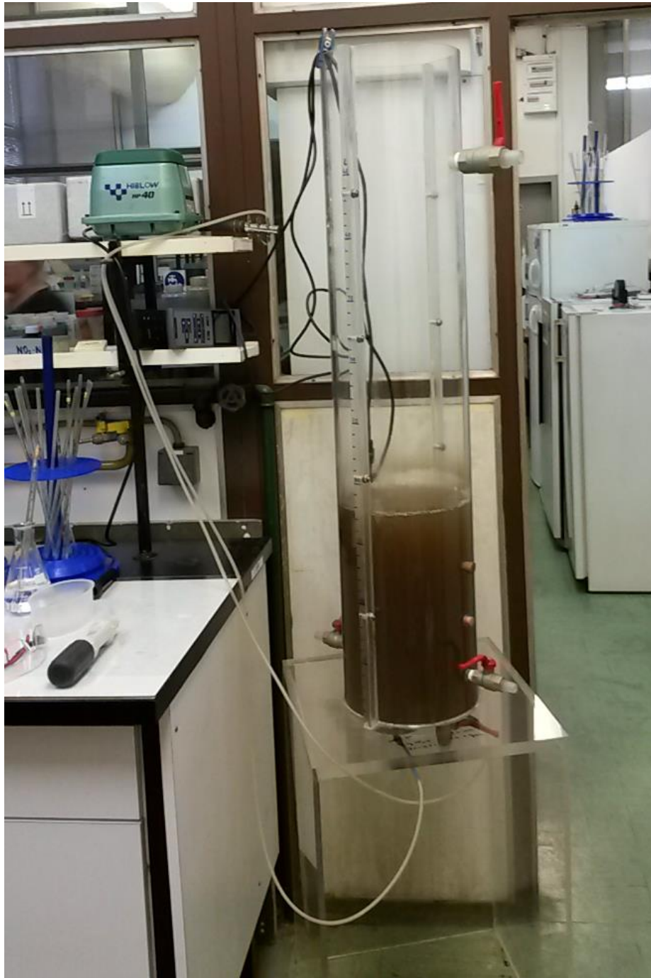
Slika 16. Laboratorijski reaktor korišten za prilagodbu aktivnog mulja na uklanjanje N
