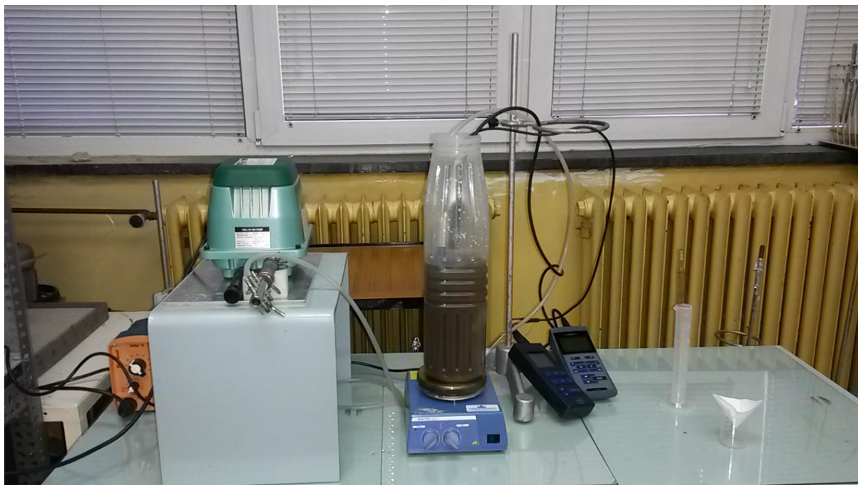
Slika 15. Aparatura za provjeru aktivnosti aktivnog mulja za uklanjanje organskih i anorganskih sastojaka. Spremnik u funkciji bioreaktora opremljen mjeračima pH, temperature i otopljenog kisika, kao i sustavom za opskrbu sa zrakom iz kompresora, postavljen na magnetskoj mješalici
