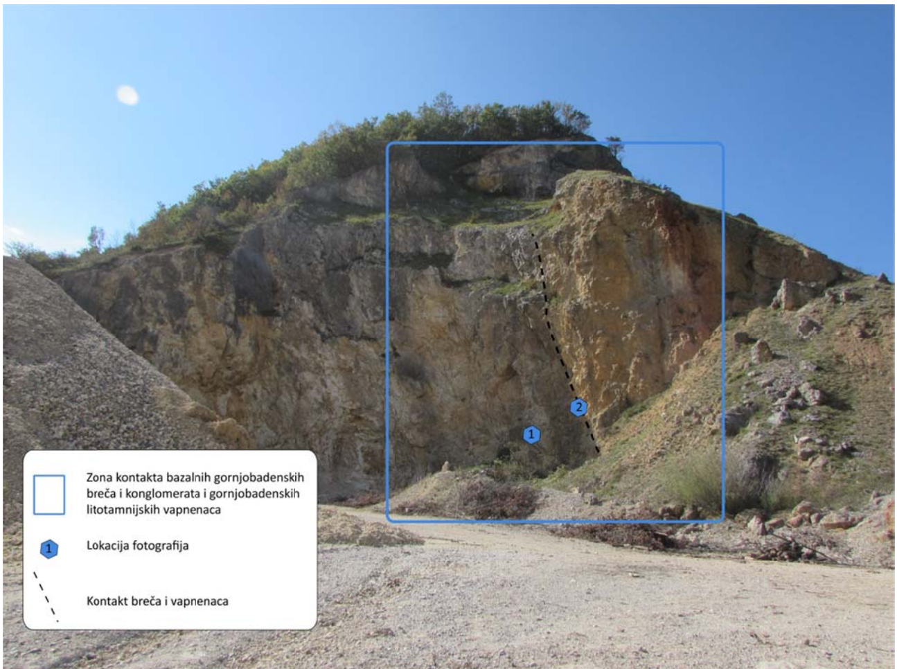
Slika 3.6. Izdanak na kojem je vidljiv kontakt bazalnih karbonatnih breča gornjeg badena i gornjobadenskih vapnenaca (kamenolom Vojnovec Kalnički).
