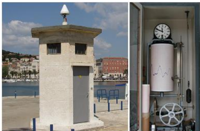
Slika 5.1. Kućica mareografa te mehanički uređaj tipa A.Ott za mjerenje visina razine mora na mareografskoj postaji Split – Luka.
