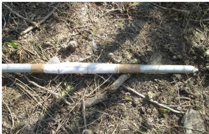
Slika 28. Prikaz piezometarske konstrukcije bušotine
