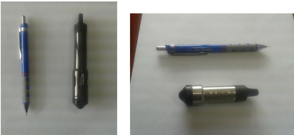
Slika 35. CTD diver (lijevo) i Baro Diver (desno)
