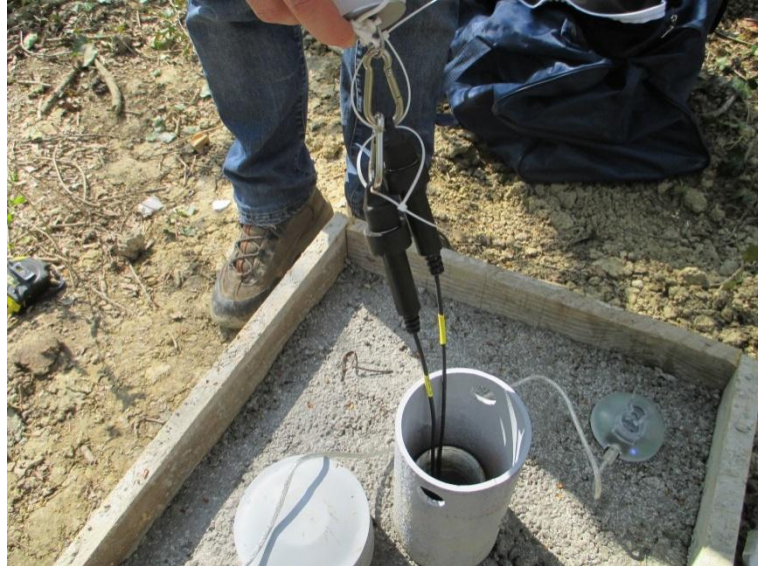
Slika 36. Postavljanje CTD i Baro divera u piezometarsku bušotinu P4
