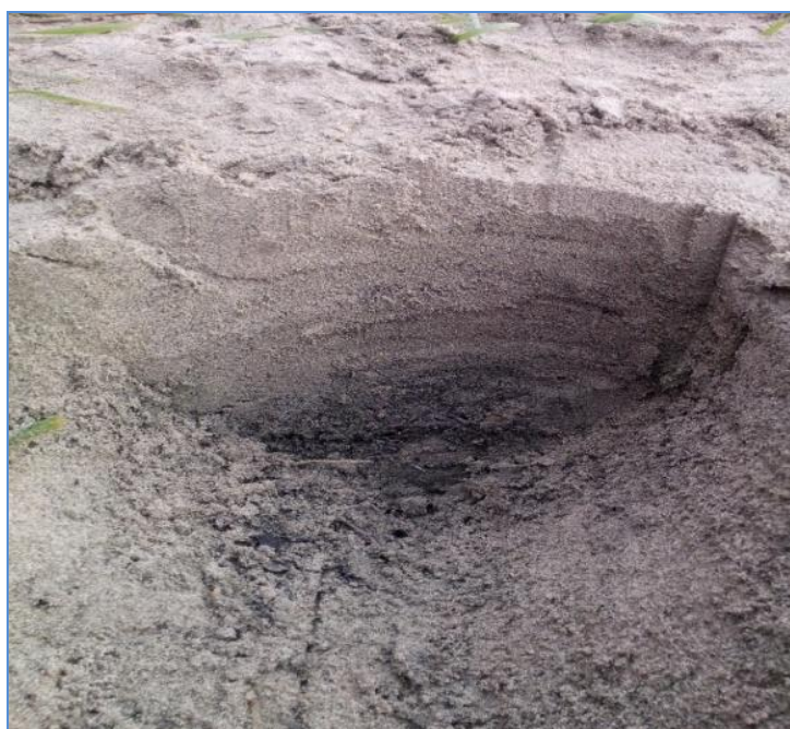
Slika 4.2-6: Profil Podsused žičara erozijsko – sedimentacijski proces nakon prolaska vodnog vala 2014
