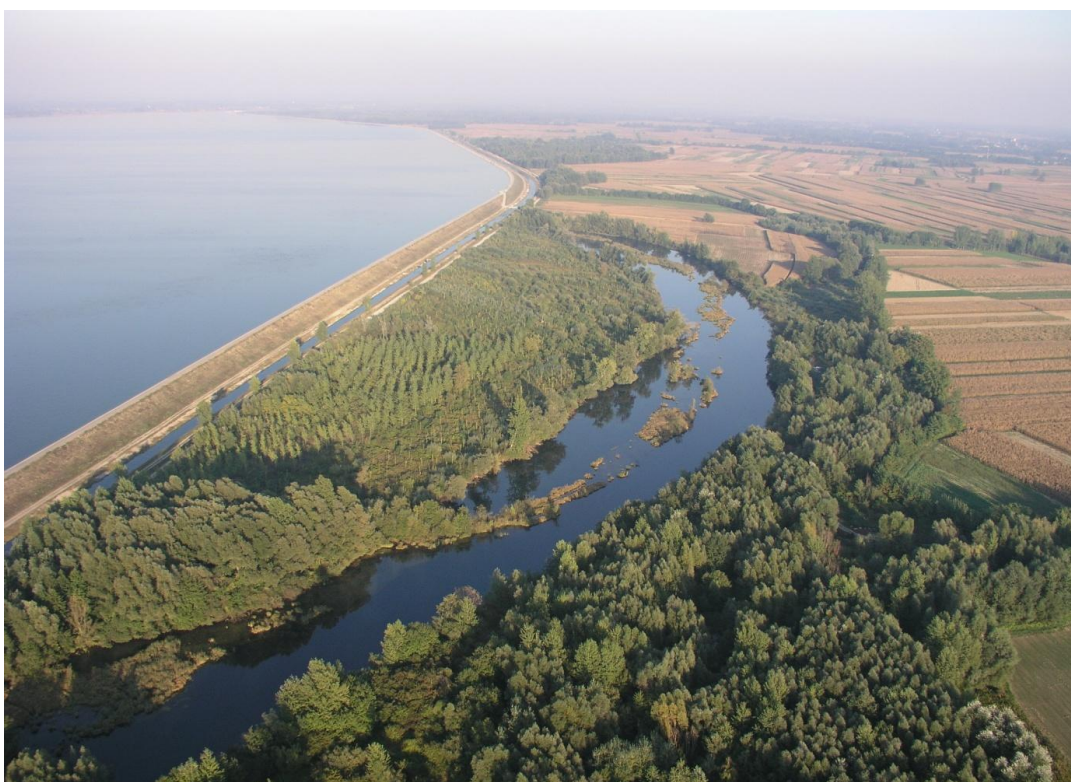
Slika 4.1.2-4: Izmjenjeno ušće pritoke u Dravu nakon izgradnje akumulacije HE Dubrava
