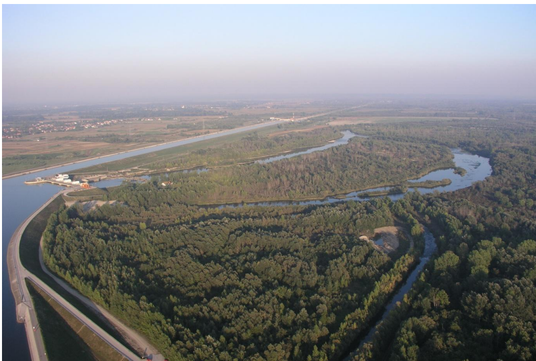
Slika 4.1.2-3: Presječeni stari meandri nakon izgradnje hidroelektrana na Dravi
