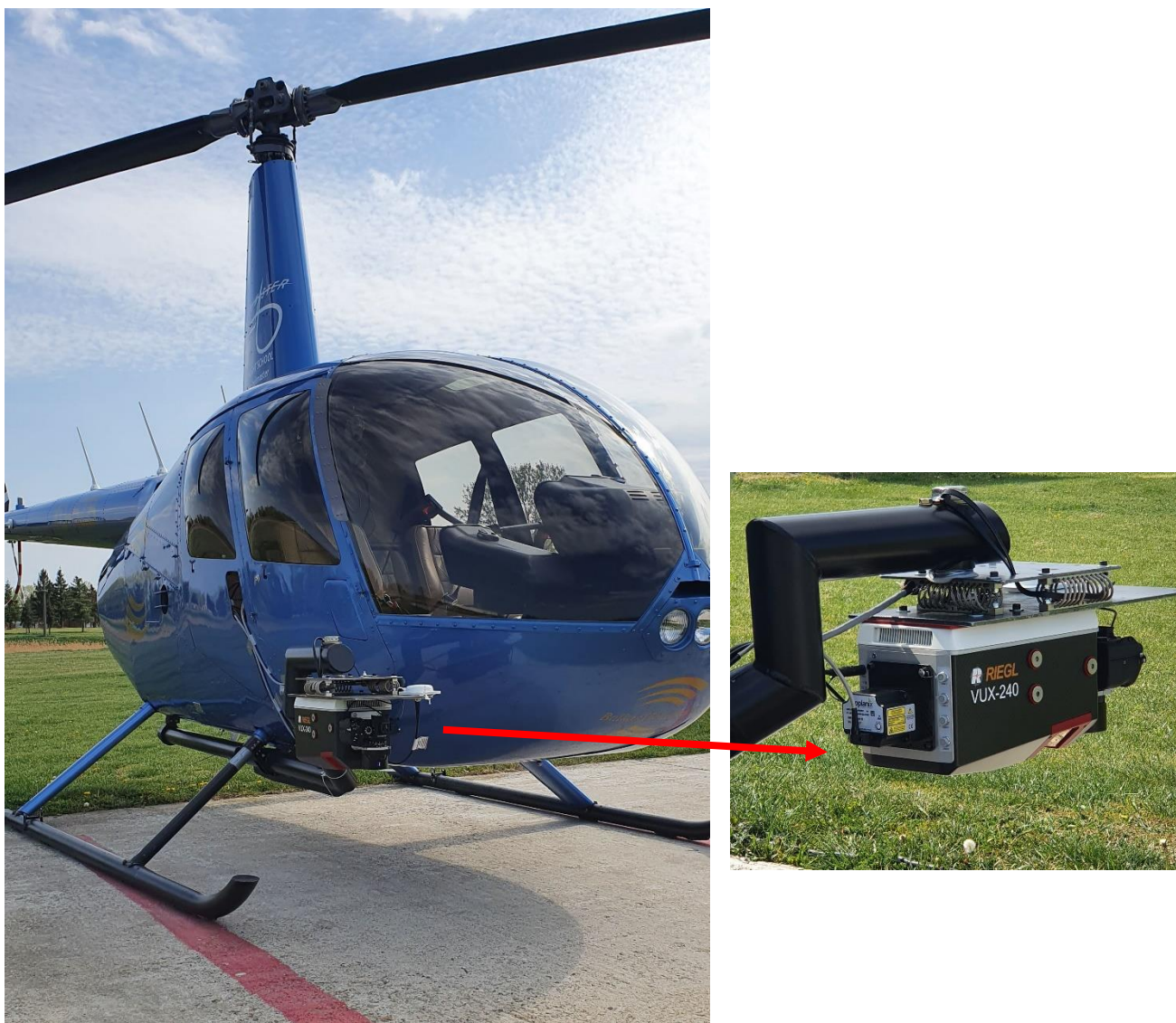
Slika 2. Zračna platforma za lasersko skeniranje sustavom RIEGL VUX 240
