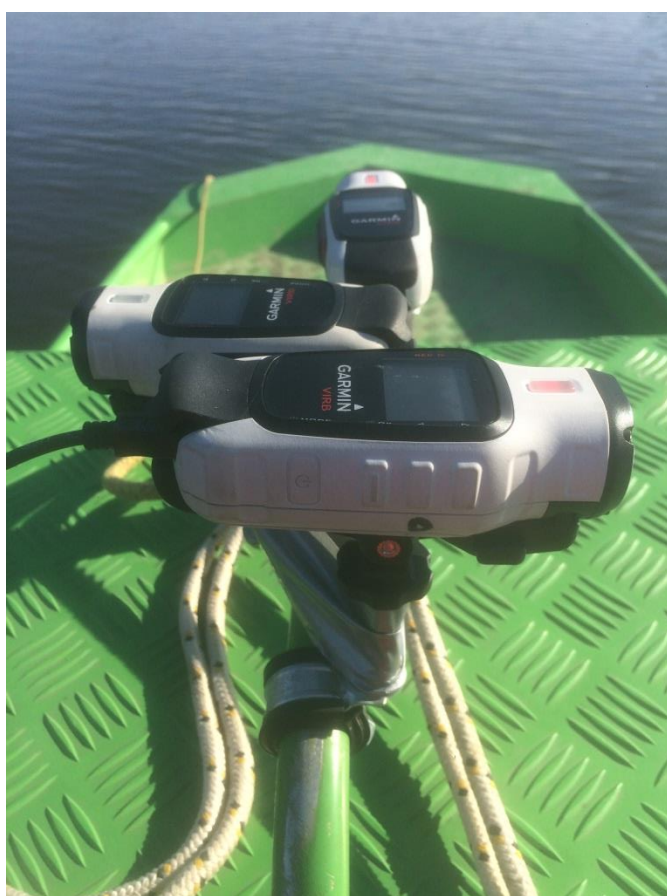
Slika 8.: Postavljene akcijske kamere za snimanje georeferenciranog videa
