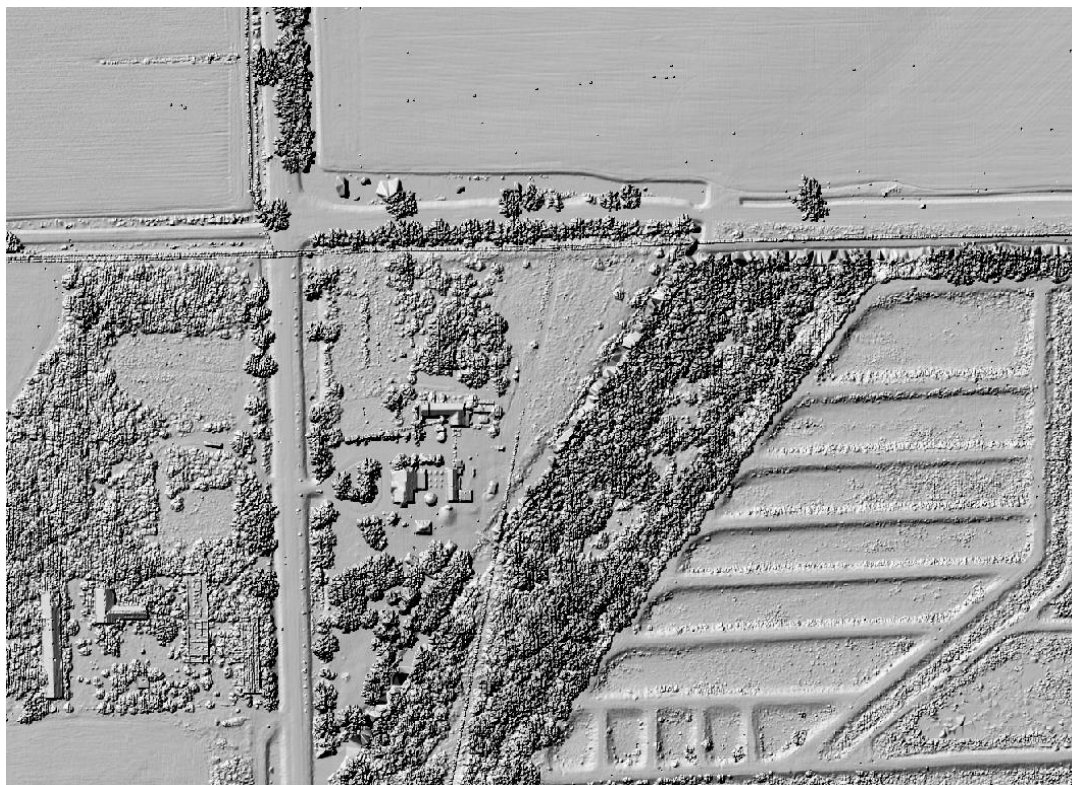
Slika 5. Digitalni Model Površina (DSM)
