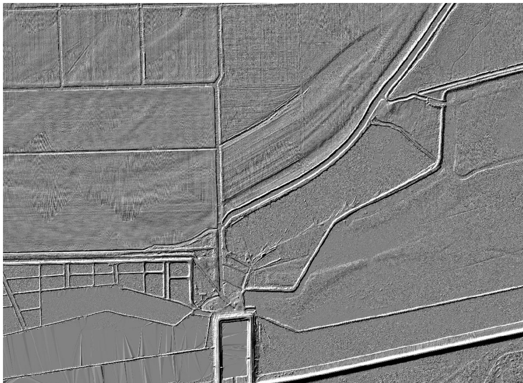
Slika 4. DTM (Digitalni Model Terena)
