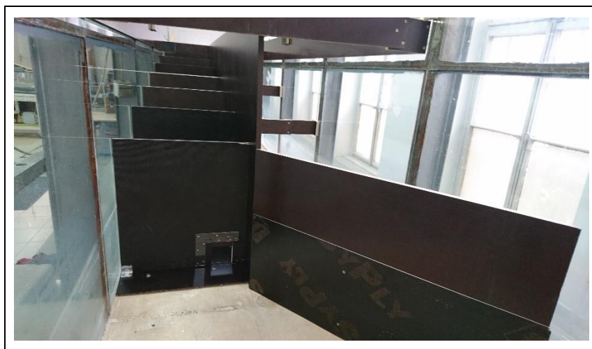
Slika 1.3. Model riblje staze bazenskog tipa u hidrotehničkom kanalu, pogled uzvodno
