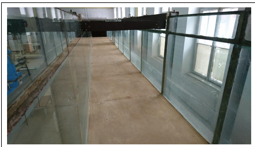
Slika 1.1. Fotografija hidrotehničkog kanala u laboratoriju zavoda za hidrotehniku, pogled uzvodno
