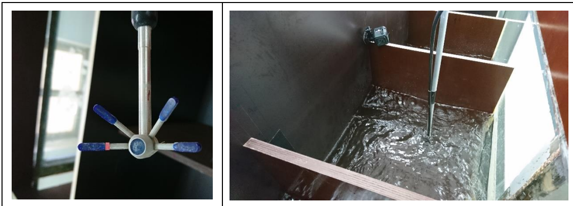
Slika 2.10. ADV uređaj (lijevo); snimanje u bazenu (desno)
