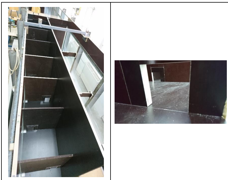
Slika 2.2. Fotografija fizikalnog modela riblje staze bazenskog tipa, pogled uzvodno (lijevo); detalj otvora (desno)
