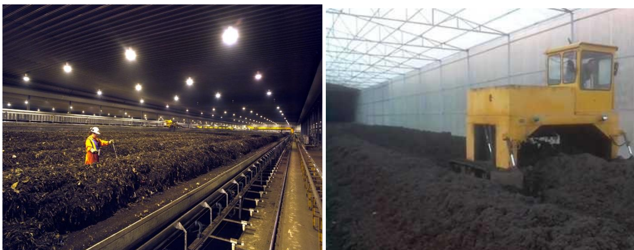
Prilog, Slika 15. Kompostana u zatvorenom prostoru – windrow sistem
