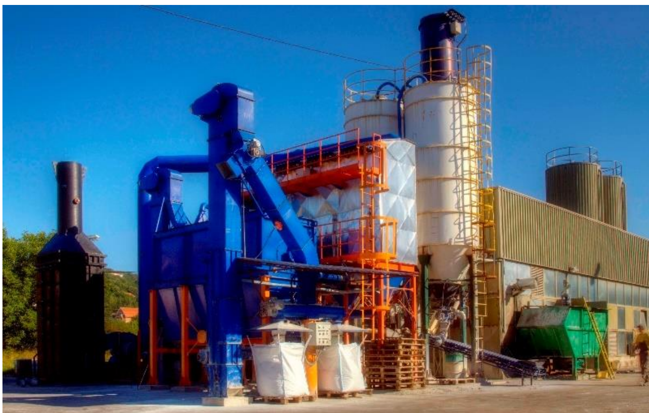
Prilog, Slika 17. MID-MIX® postrojenje za solidifikaciju mulja
