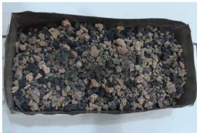
Prilog, Slika 20. Užareni mulj tijekom spaljivanja i granule stvrdnutog pepela nakon spaljivanja na 800°C (istraživanje u sklopu projekta „RESCUE“ na Građevinskom fakultetu u Zagrebu)
