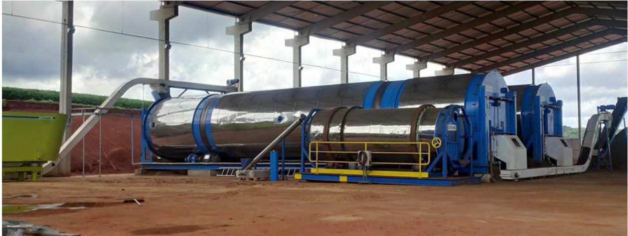
Prilog, Slika 16. Kompostana mulja – in-vessel sistem
