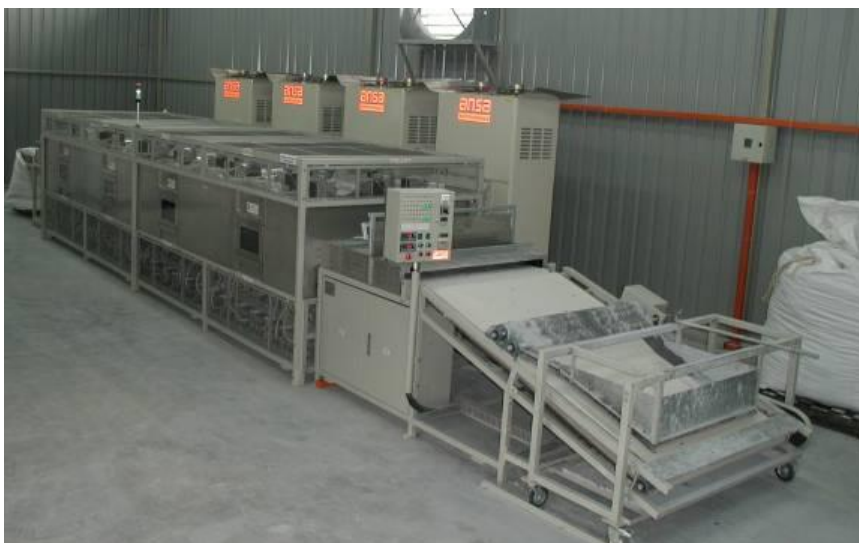
Prilog, Slika 4. Uređaj za mikrovalno sušenje mulja tvrtke Ansa Technology iz Kine.
