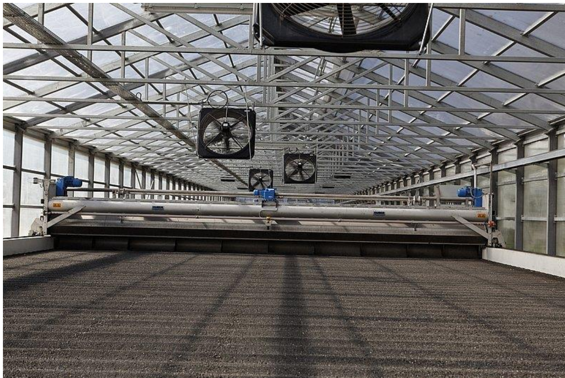
Prilog, Slika 11. Izvedeni pogoni za solarno sušenje mulja (2)
