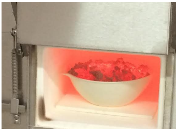
Prilog, Slika 20. Užareni mulj tijekom spaljivanja i granule stvrdnutog pepela nakon spaljivanja na 800°C (istraživanje u sklopu projekta „RESCUE“ na Građevinskom fakultetu u Zagrebu)
