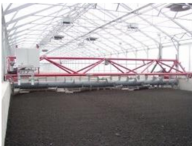
Prilog, Slika 10. Izvedeni pogoni za solarno sušenje mulja (1)
