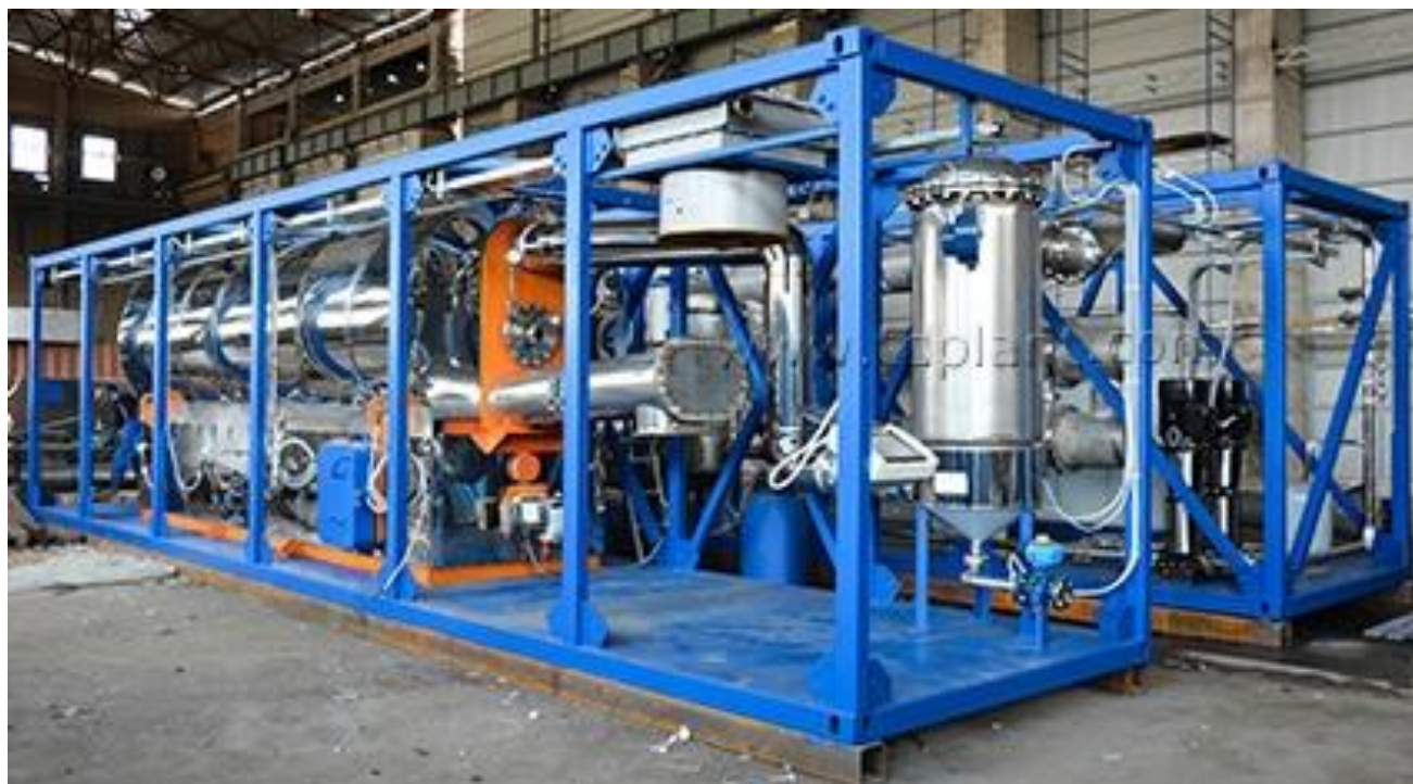
Prilog, Slika 25. Postrojenje pirolize u modulske izvedbi
