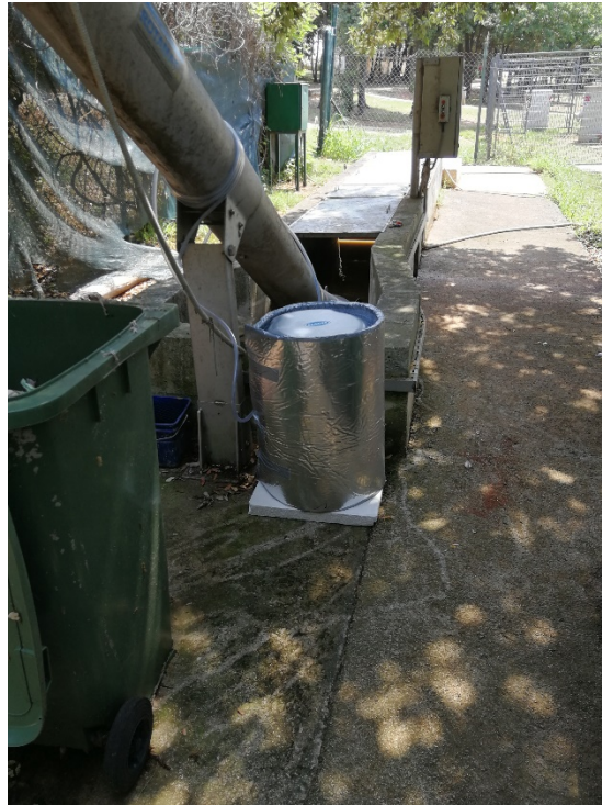
Slika 2. Uzorkivač na lokaciji ispusta Lanterna koji je uzorkovao otpadnu vodu iza sita
