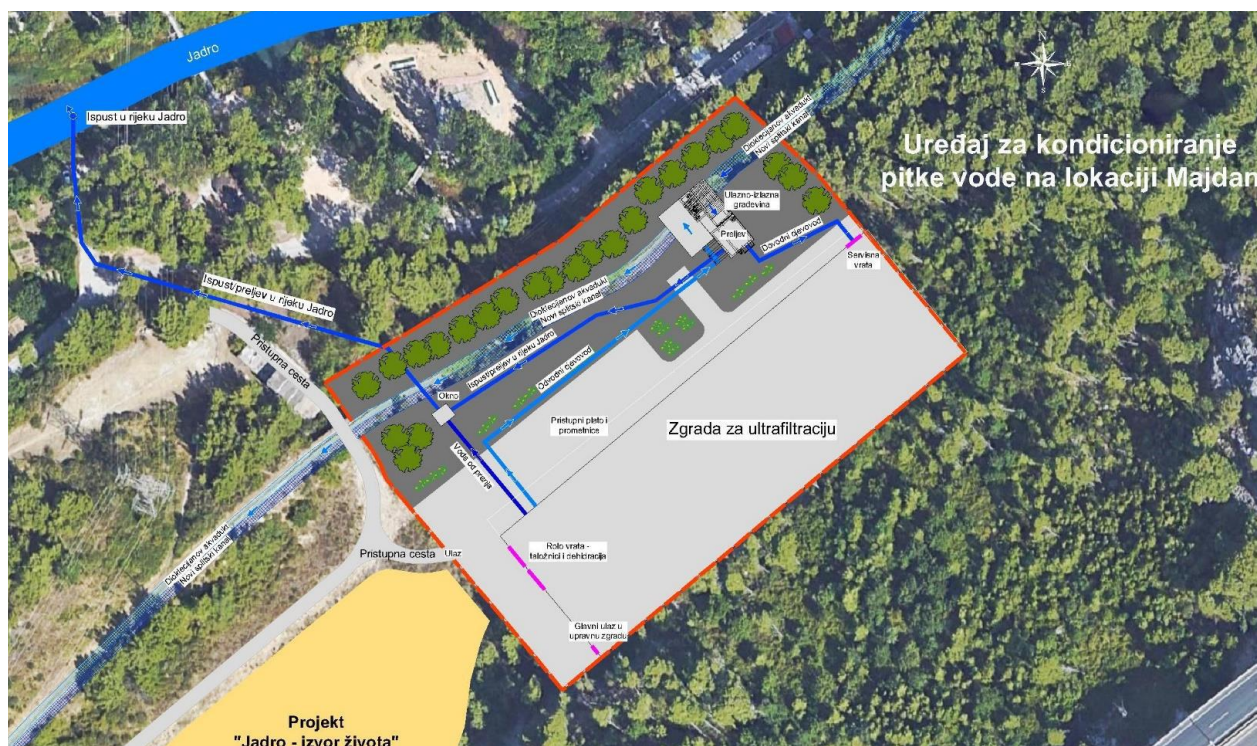
Slika 16: UKPV Jadro na Majdanu - situacijski prikaz planiranog uređaja (izvor: EZO UKPV s izvora r. Jadro)
