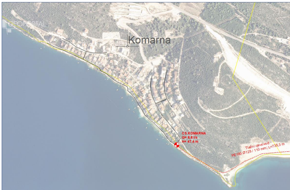
Slika 3-30 Postojeći i sustav odvodnje u izgradnji na području naselja Komarna
