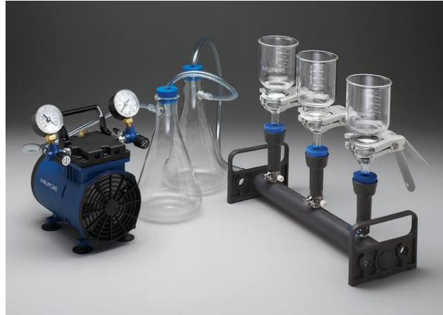
Slika 4.2. Uređaj za vakum filtriranje morske vode
