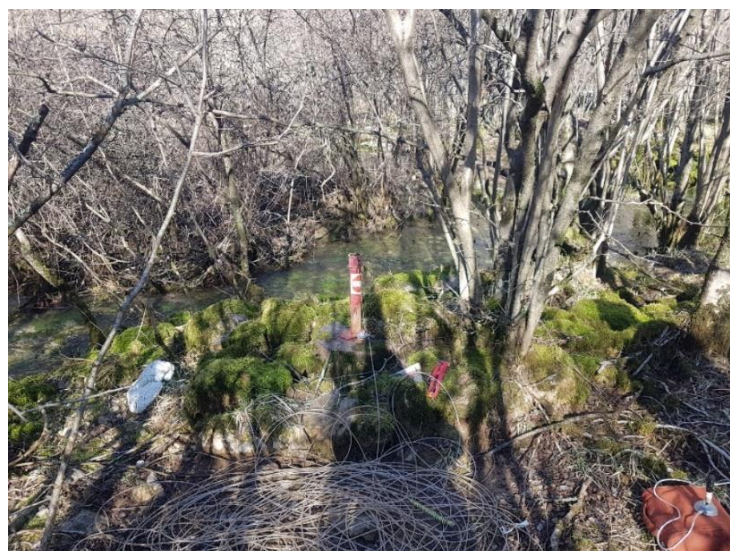
Slika 4.5 Skidanje podataka s logera na piezometru B-1 (Lužac) uz koga protječu vode koje su je javile na površini terena u istoimenoj izvorskoj zoni
