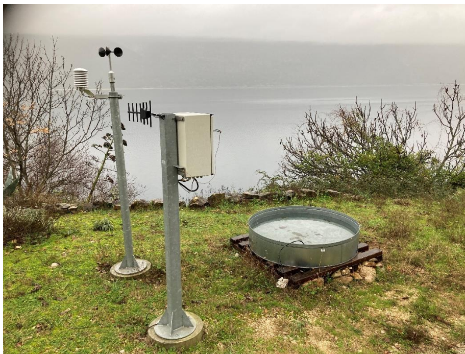
Slika 2.1.2. Automatski isparitelj klase A na lokaciji Vransko jezero-Cres
