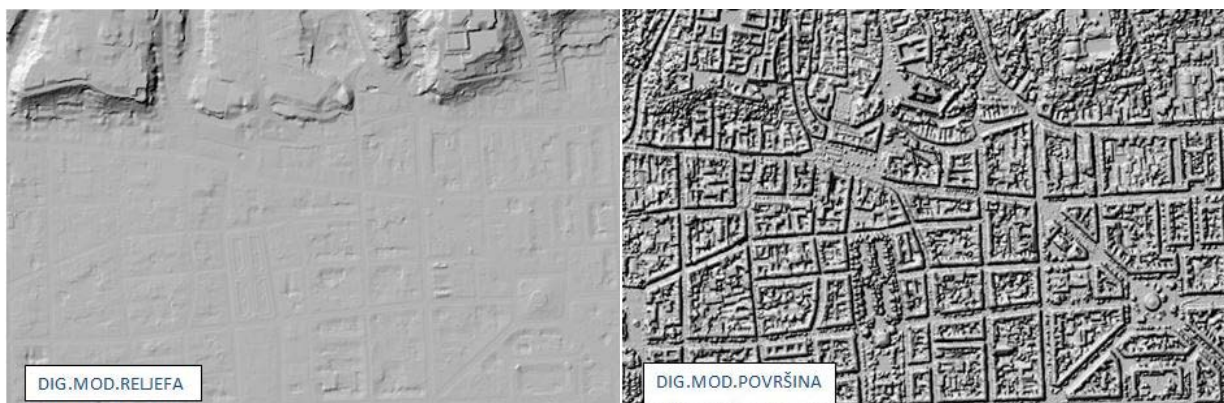
Slika 4.9: Izvedenice LiDAR podataka za područje Zagreba
