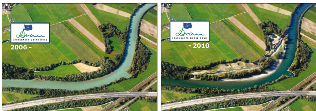
Slika 16. Revitalizacija riparijske zone s barama i novim rukavcem na sekciji Drave kod Obergottesfelda prije i neposredno nakon zahvata [18]
