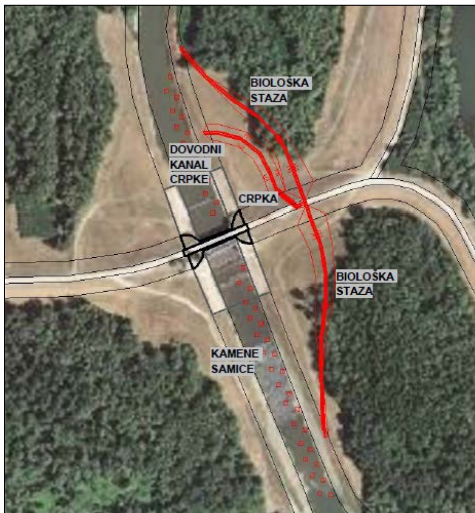
Slika 95. Situacijski prikaz biološke riblje staze i kamenih samaca u kanalu ustave [4]
