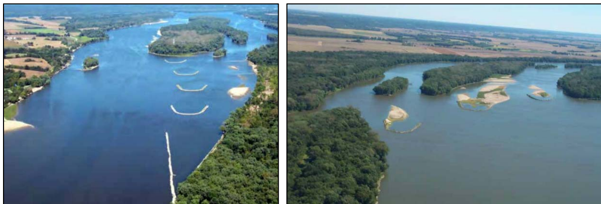
Slika 23. Chevronska pera za održavanje plovnih putova (lijevo) i zaštitu riječnih ada od erozije (desno) [9]
