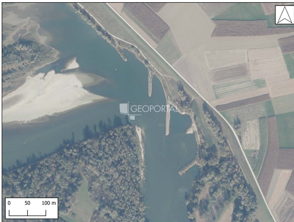
Slika 21. Regulacijska pera na rijeci Dravi u Hrvatskoj kod Gabajeve Grede, 1:5.000 (DOF)
