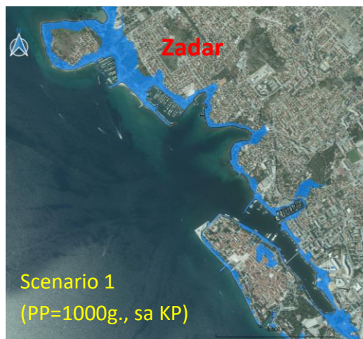
Slika 6.5. Prikaz područja plavljenja na obalnom području RH u GIS sučelju (raster 5m x 5m) pri ekstremnim razinama mora i bez djelovanja valova (model SCHISM). Prikaz se odnosi na usvojene scenarije 4 i 6
