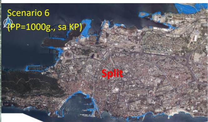
Slika 6.5. Prikaz područja plavljenja na obalnom području RH u GIS sučelju (raster 5m x 5m) pri ekstremnim razinama mora i bez djelovanja valova (model SCHISM). Prikaz se odnosi na usvojene scenarije 4 i 6
