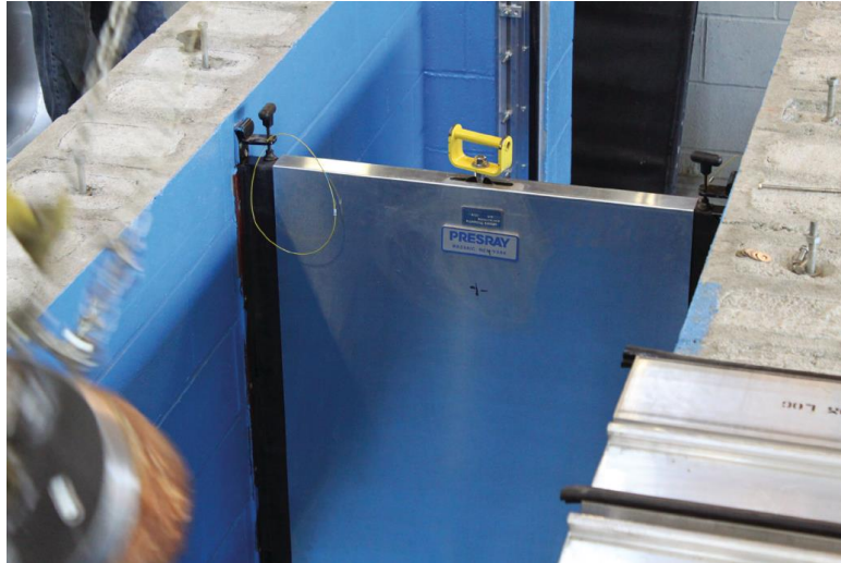
Slika 7.20. Primjer prethodno ugrađenih mobilnih barijera, lagane konstrukcije s ručnim izdizanjem (izvor Presray)
