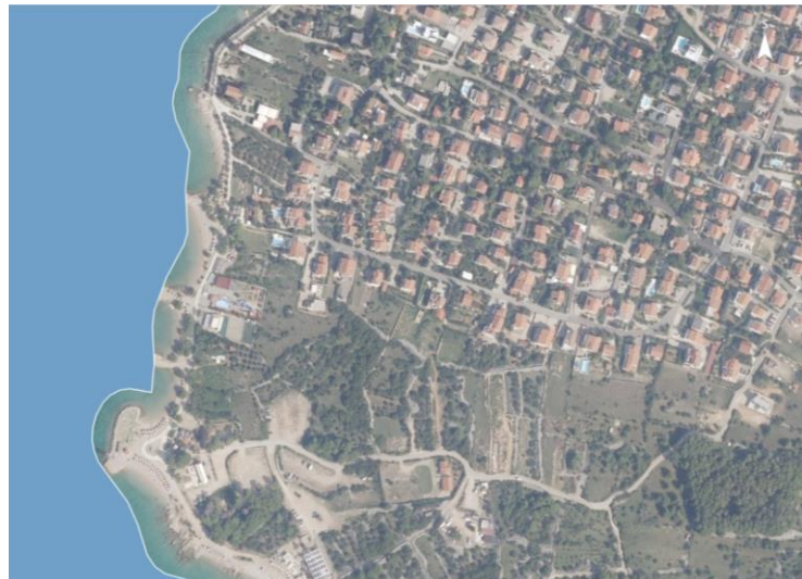
Slika 7.12. Primjer izgradnje pera te formiranje plaže i obalnog područja uz vidljivu urbanizaciju zaleđa na području Punta-Buka na otoku Krku (izvor DGU i GoogleEarth)
