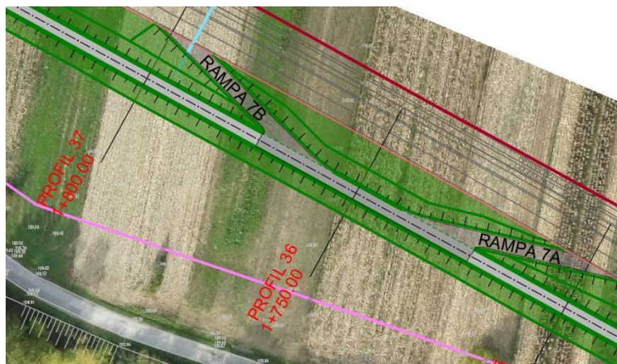
Slika II-17 Situacijski prikaz pristupnih rampi 7A i 7B
