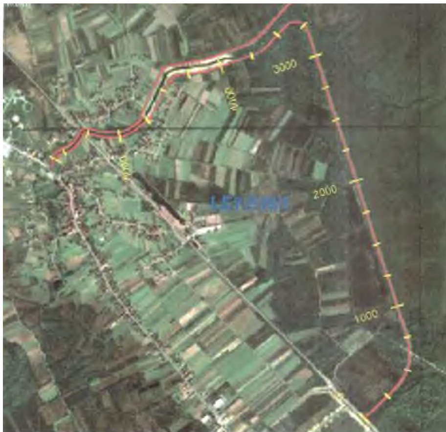
Slika 1.2. Situacijski prikaz desnog nasipa za zaštitu naselja Lekenik
