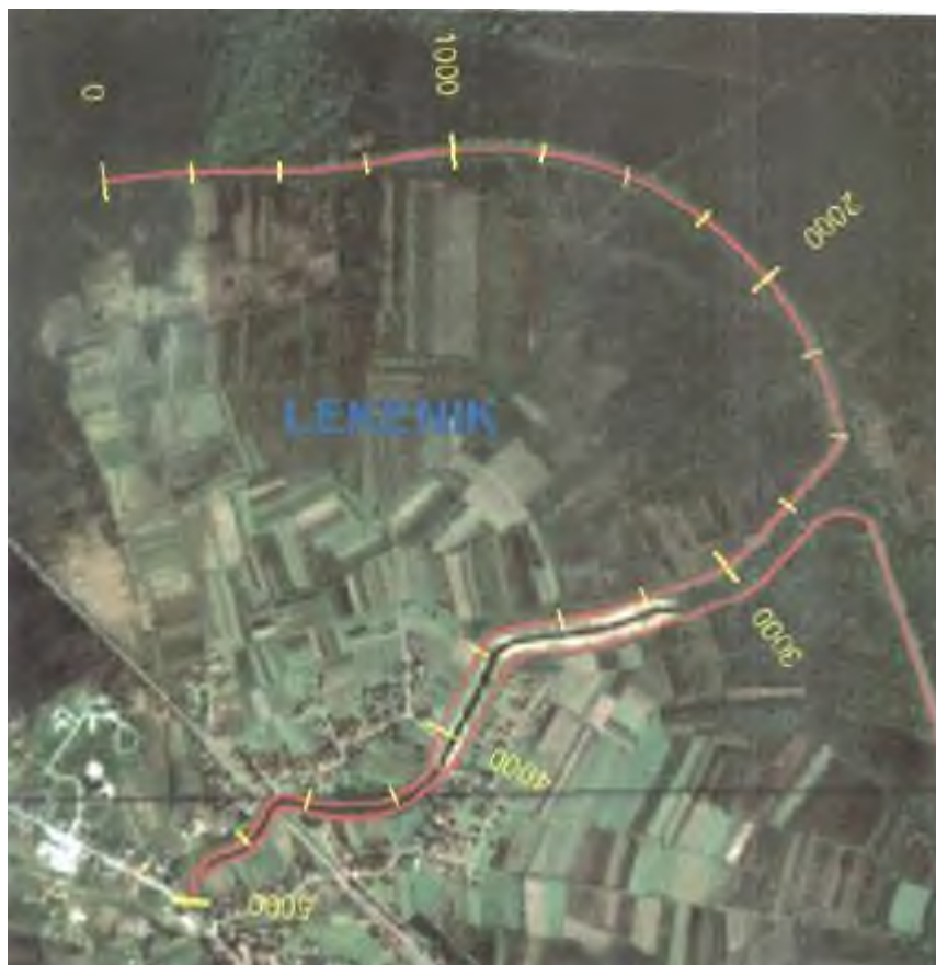
Slika 1.1. Situacijski prikaz lijevog nasipa za zaštitu naselja Lekenik
