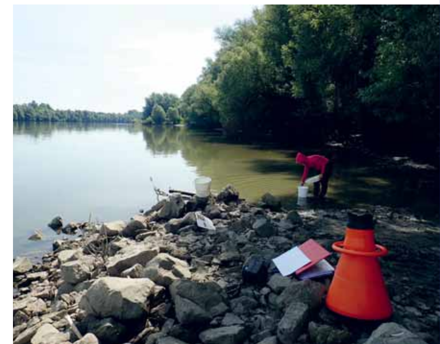
Fitobentos se uzorkovao struganjem alga kremenjašica s pet kamena srednje veličine uz spremanje u bočice, postaja Drava 5 km prije utoka u Dunav (JDS4-30), Hrvatska
