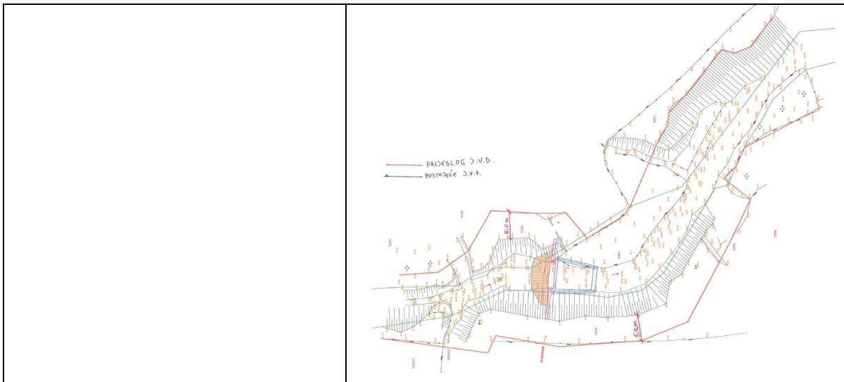
Na jadranskom vodnom području bujični vodotoci su često regulirani kinetiranjem. Širine kineta variraju od 1,0 m do 5,0 m. Budući da su iste građevinski dovršene, potreban je određeni pojas za održavanje, uglavnom čišćenje. Zbog visoke cijene zemljišta u uglavnom urbanim područjima, javno vodno dobro treba biti obostrani pojas za održavanje širine 3,0 m, koji sa širinom kinete čini česticu javnog vodnog dobra.
