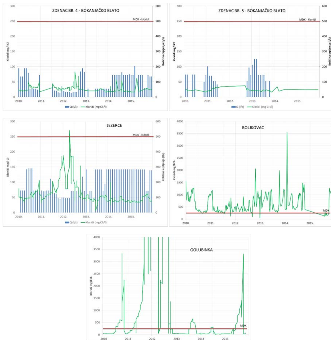
Slika 15.2-8. Koncentracije klorida na vodocrpilištima na području CPV Bokanjac-Poličnik
