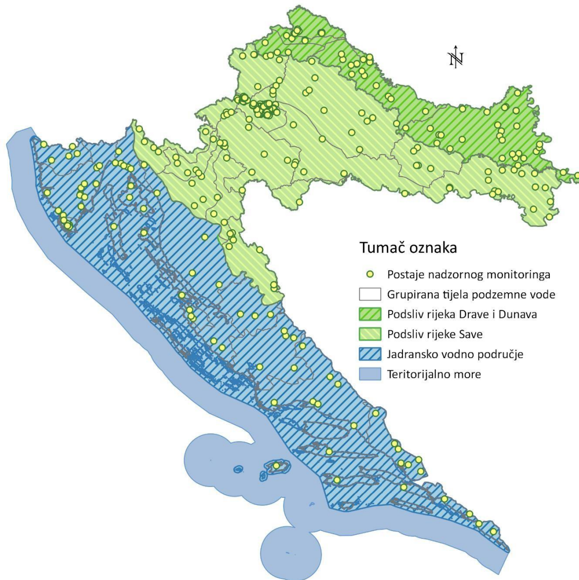
Slika 2. Postaje nadzornog monitoringa podzemnih voda
