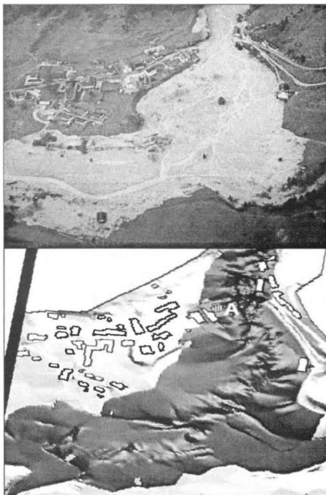
Slika 6: Poređenje osmatranja i rezultata računa; Gore: aero-foto blatnog toka u Gorenjem Logu (foto: B. Vlaj, 22.11.2000.); Dole: prikaz izračunatih (PCFLOW2D) maksimalnih dubina blatnog toka
