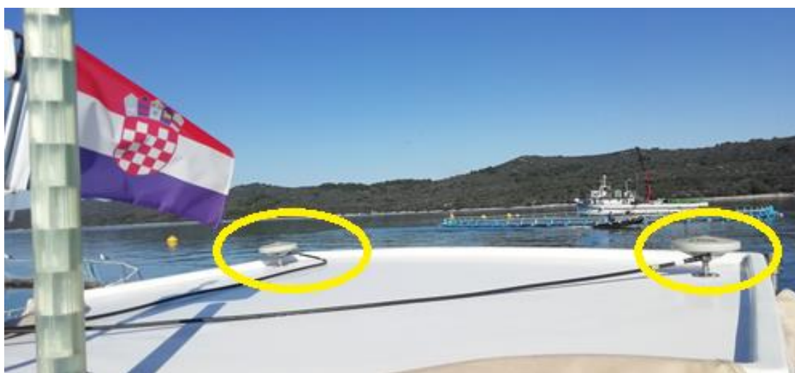
Slika 7. GNSS antene
