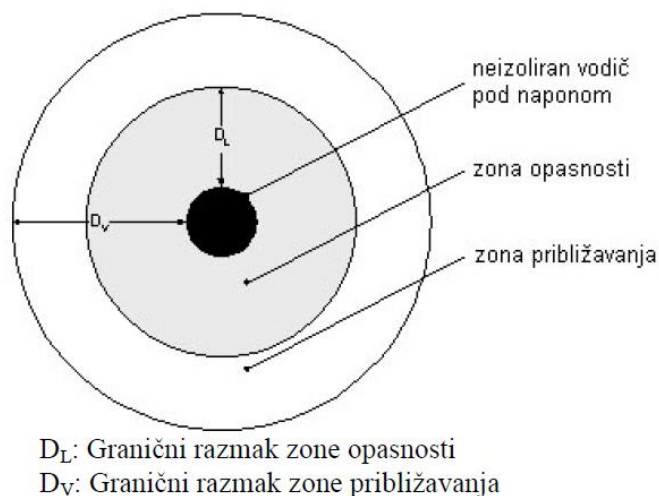
Slika 1. - Sigurnosni razmaci u zraku i podjela prostora na zone
