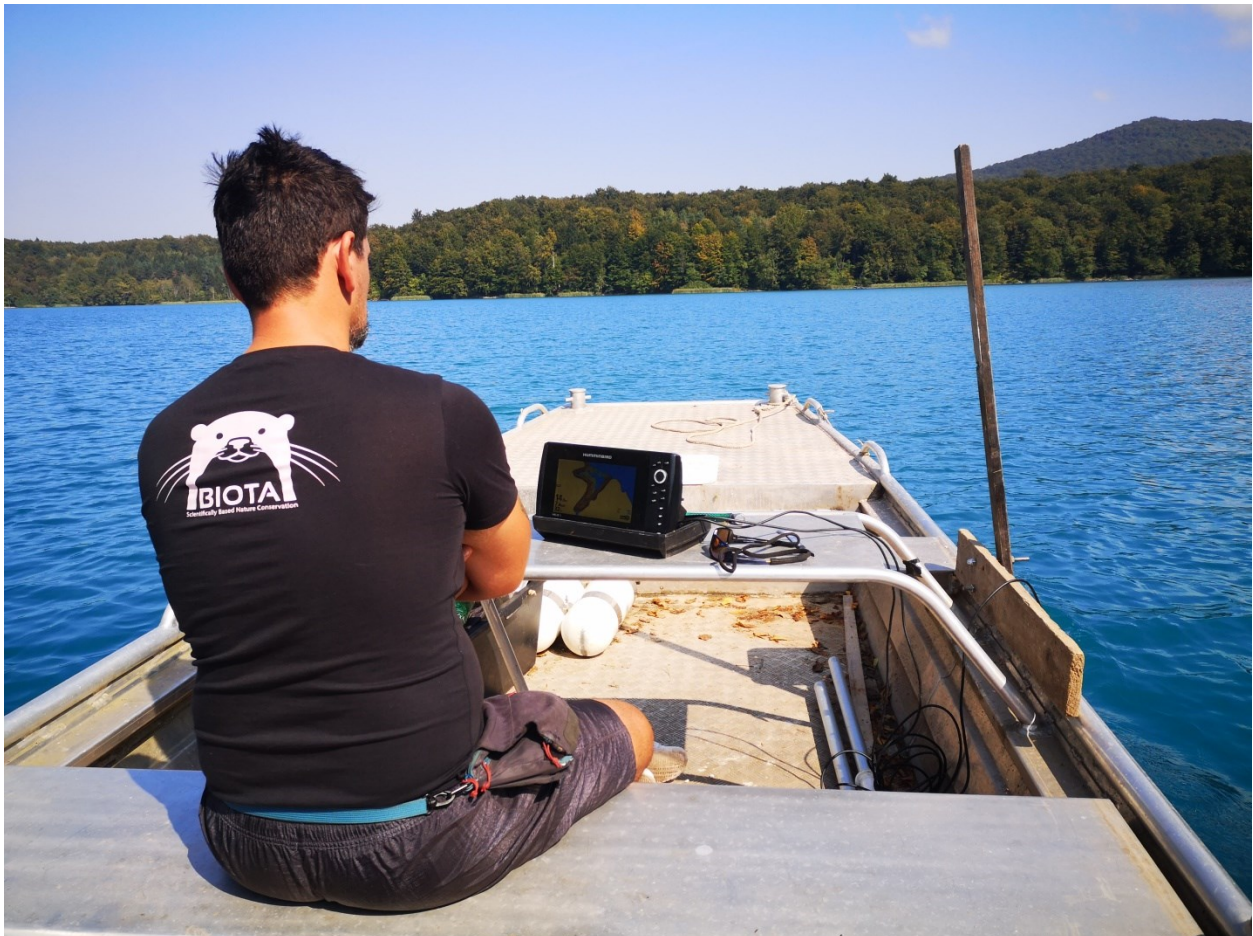
Slika 3. Snimanje jezera Kozjak side-scan multi beam sonarom.
