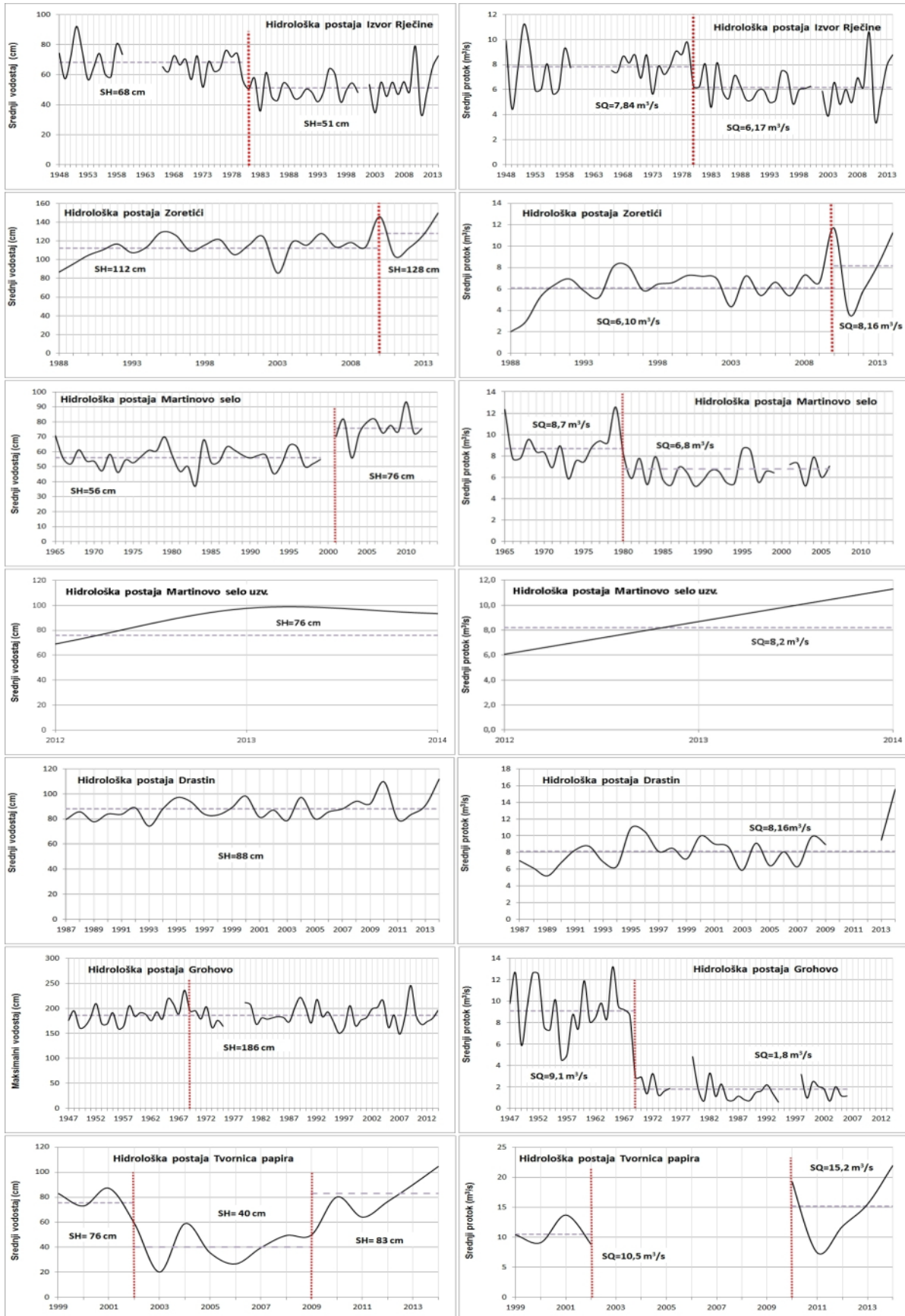
Slika 2.1-11 Nivogram srednjih godišnjih/maksimalnih vodostaja (lijevo) i hidrogram srednjih godišnjih protoka (desno) za hidrološke postaje na rijeci Rječini.
