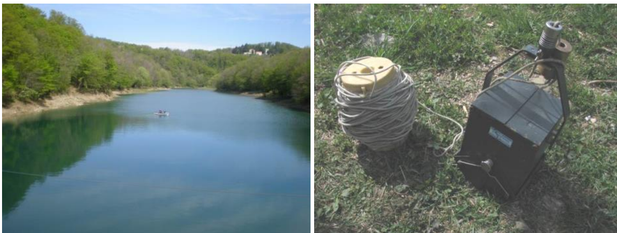
Slika 2.3-14 Uzorkovanje na akumulaciji Valići (lijevo) pomoću Eckmannovog grabila (desno) (foto: J. Šargač).
