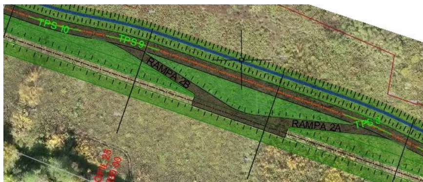
Slika II-28 Situacijski prikaz pristupnih rampi 2A i 2 B
