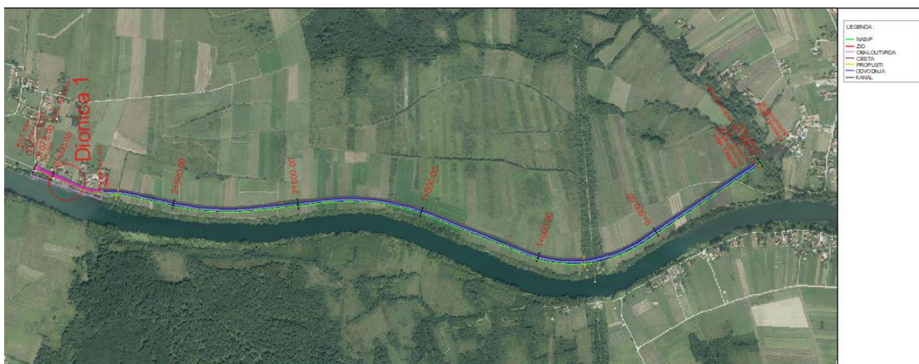
Slika III-1 Pozicije izmještanja vodovoda u okviru etape 5
