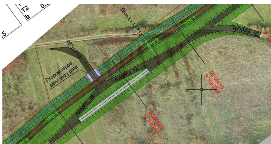
Slika II-27 Situacijski prikaz pristupnih rampi 1A – 1C
