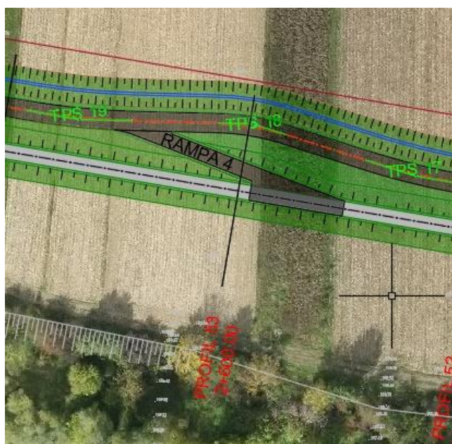
Slika II-30 Situacijski prikaz pristupne rampe 4
