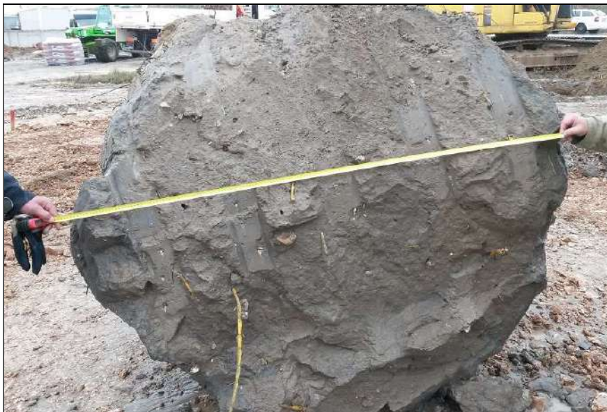
Slika 9 - Odlomljeni presjek izvedenog stupnjaka
