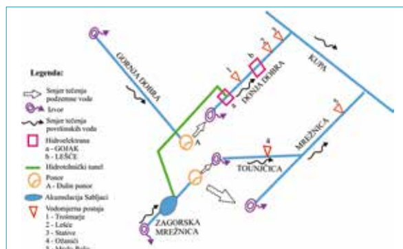
Slika 8: Shematska situacija slivova Gornje i Donje Dobre te Zagorske Mrežnice, Tounjčice i Mrežnice s ucrtanim položajem akumulacije Sabljaci, hidroelektrana Gojak i Lešće te pet hidroloških postaja čiji su srednji godišnji protoci analizirani u ovom radu
