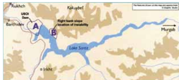
Slika 19 Brana Usoi „A“ i potencijalno klizište na sjevernoj obali „B“ (iz Usoi Dam Wave Overtopping and Flood Routing in the Bartang and Panj Rivers, Tajikistan, J. Risley, J. Walder, and R. Denlinger U.S. Agency for International Development.)
