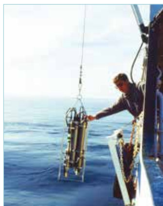
Slika 13. Mjerenje termohalinih svojstava mora CTD sondom; Nenad Leder na brodu „Andrija Mohorovičić“, 1995. godine (Foto: D. Viličić).
