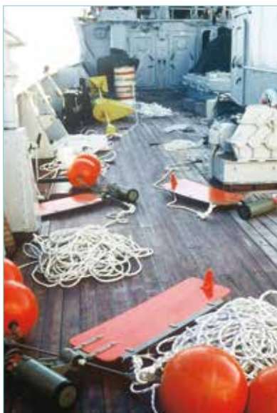
Slika 21. Pripreme za polaganje mehaničkih strujomjera na palubi broda „Andrija Mohorovičić“ 1990. godine (Foto: D. Viličić).
